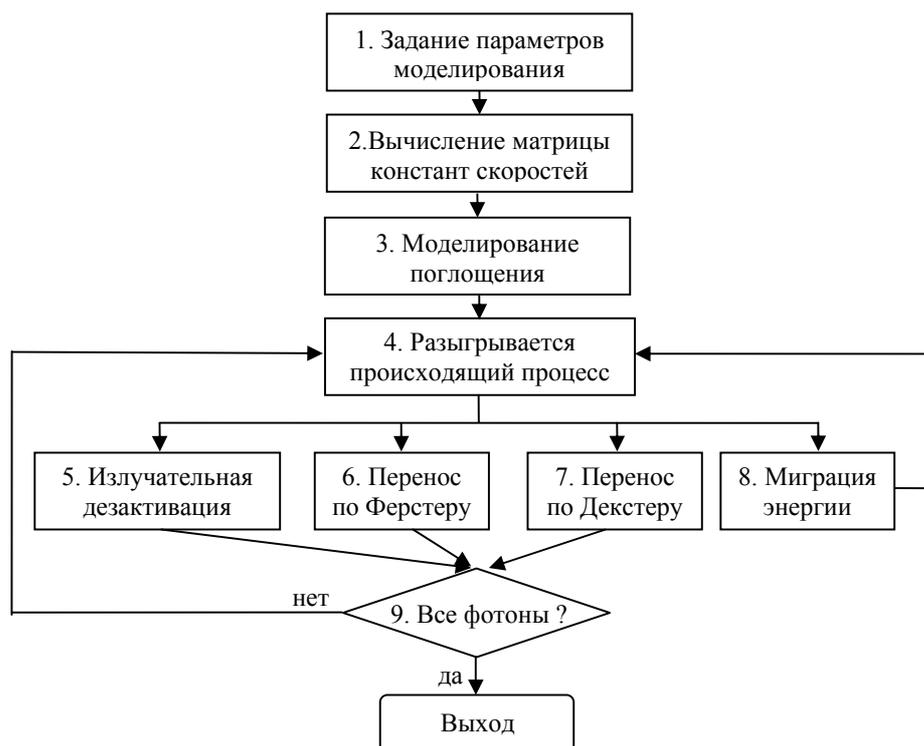
Рисунок 18 – Результирующая блок-схема моделирования преобразования энергии
